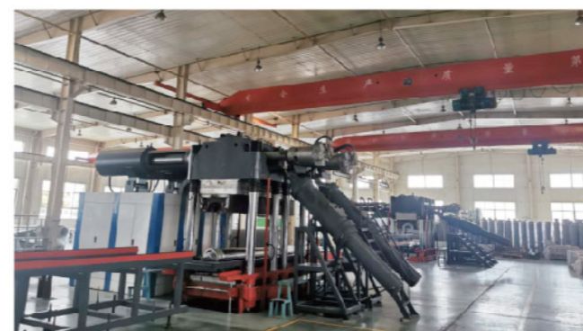
Литье под давлением оболочки из силиконовой резины (метод HTV)
