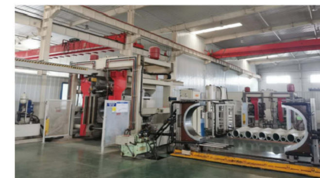
Литье под давлением оболочки из силиконовой резины (метод LSR)
