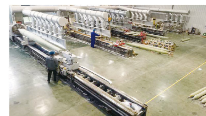
Механическая обработка конденсатора ввода
