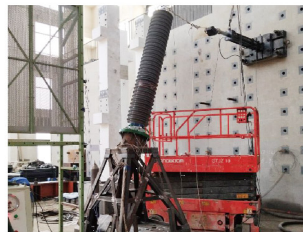
Пройдены сейсмические испытания с горизонтальным ускорением (0,75 g) и вертикальным синусоидальным резонансным ударом (0,375 g)
