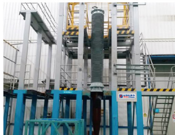
Стенд сборки ввода с композитной оболочкой
