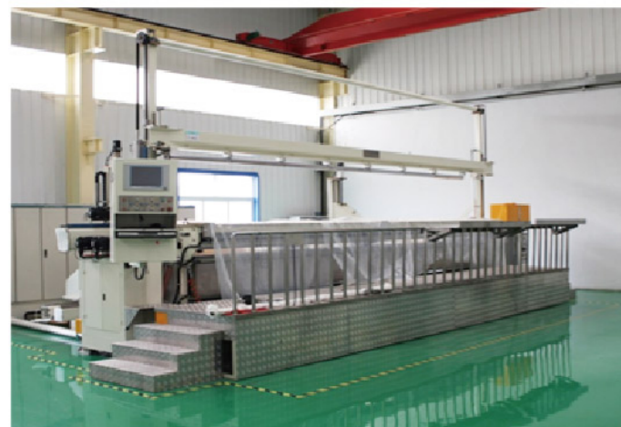
Линия намотки конденсатора ввода
